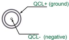
Figure 6. SMA Pin-Out
