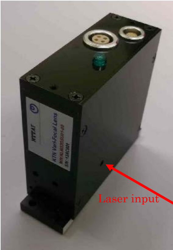
【Figure 2 Picture of a vari-focal lens module】
